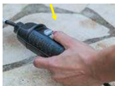
3. Drücken Sie die Test-Taste, die Anzeige erlischt.
